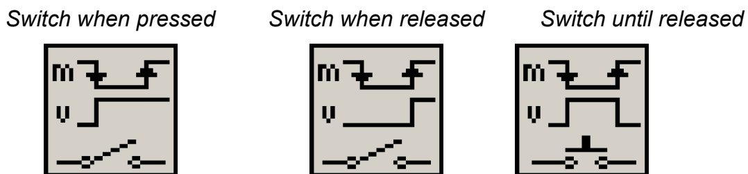
Figura 2.52. Acciones Mecánicas tipo Switch .
