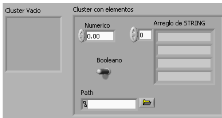
Figura 3.35. Cluster vacío y con controles.
