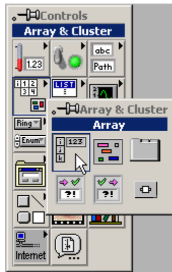
Figura 3.1. Paleta de controles Array&Cluster .
