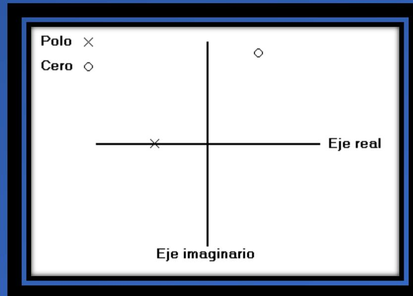
Según la posición de los polos podemos determinar si un sistema es estable o no
