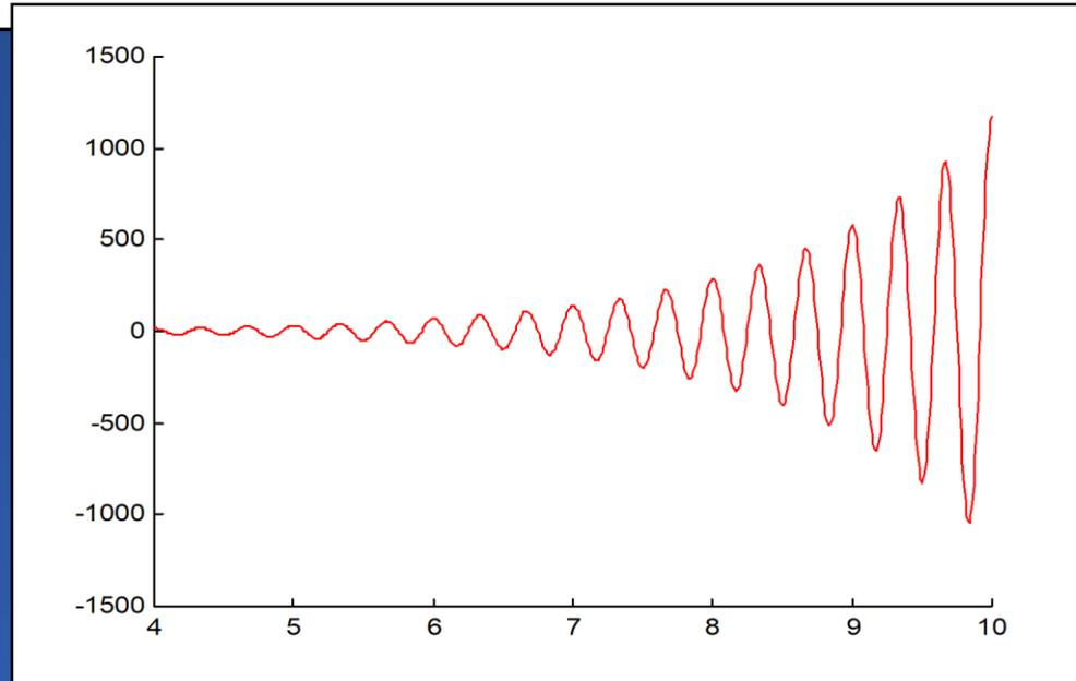
Es necesario por tanto, que a medida que la amplitud crezca, se produzca un cambio en uno o más de los parámetros de la red (generalmente la amplificación) tal que los polos conjugados **se muevan en dirección al eje imaginario**. Al final, en alguna amplitud predeterminada de la onda sinusoidal, los polos **alcanzan el eje imaginario** y se logra una salida **sinusoidal de amplitud constante**.
