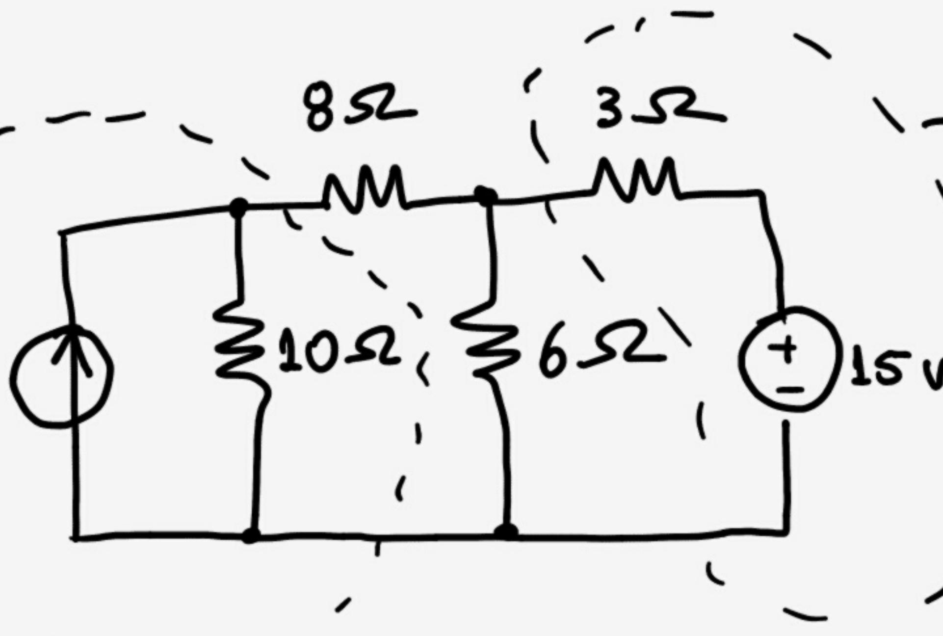
→ Transformamos en fuente de corriente en paralelo con la resistencia:
