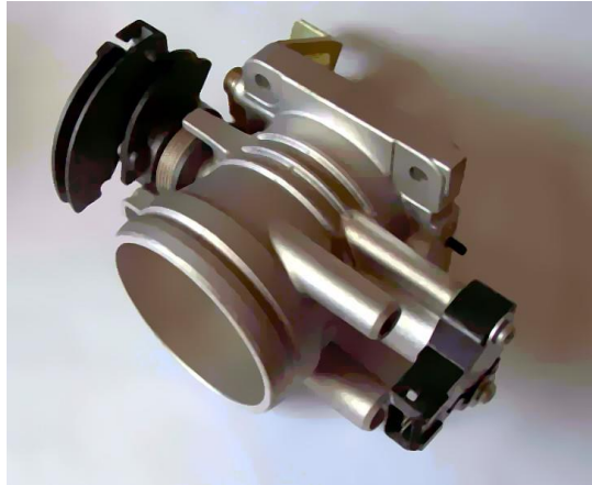
Figura 1-4 Válvula mariposa. En el extremo derecho se ve acoplado el sensor potenciométrico.
