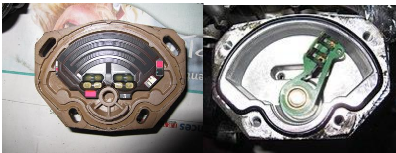
Figura 1-5 Sensor de posición de válvula mariposa: Pista de material resistivo (izquierda) y contacto deslizante (derecha)
